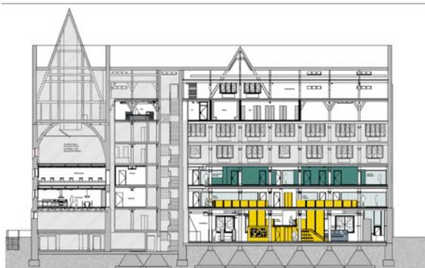
Abb. 2: Ein Planungsschnitt durch alte Gemäuer, gut sichtbar das stählerne Raummöbel in der Bibliothek, die Küchen. Grafik: ff-Architekten Feldhusen Fleckenstein PartG mbB, Berlin.
